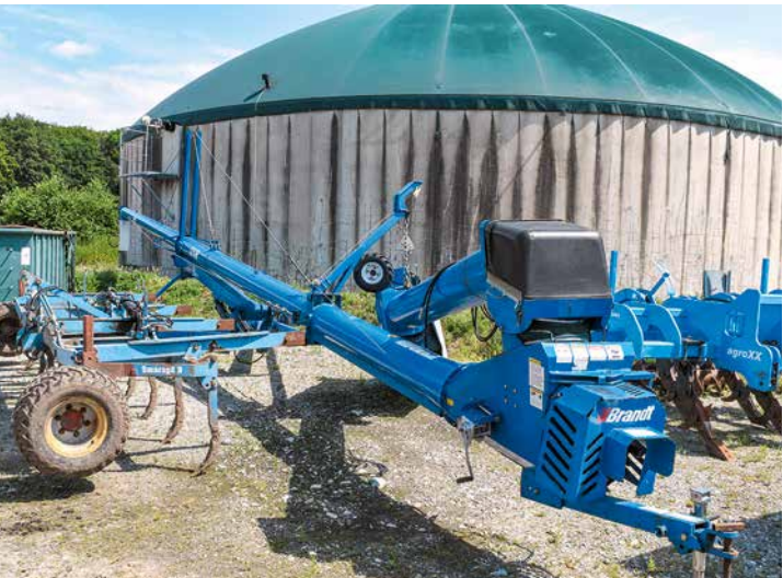
△ Die Förderschnecke zum Einlagern ist zweigeteilt. Der starre Teil wird per Traktor positioniert. Der kürzere Teil lässt sich dann hinter einen Kipper schwenken. Die Schnecke fördert das Getreide von oben ins Silo. Ein drehender, achtarmiger Stern verteilt das Getreide gleichmäßig.
