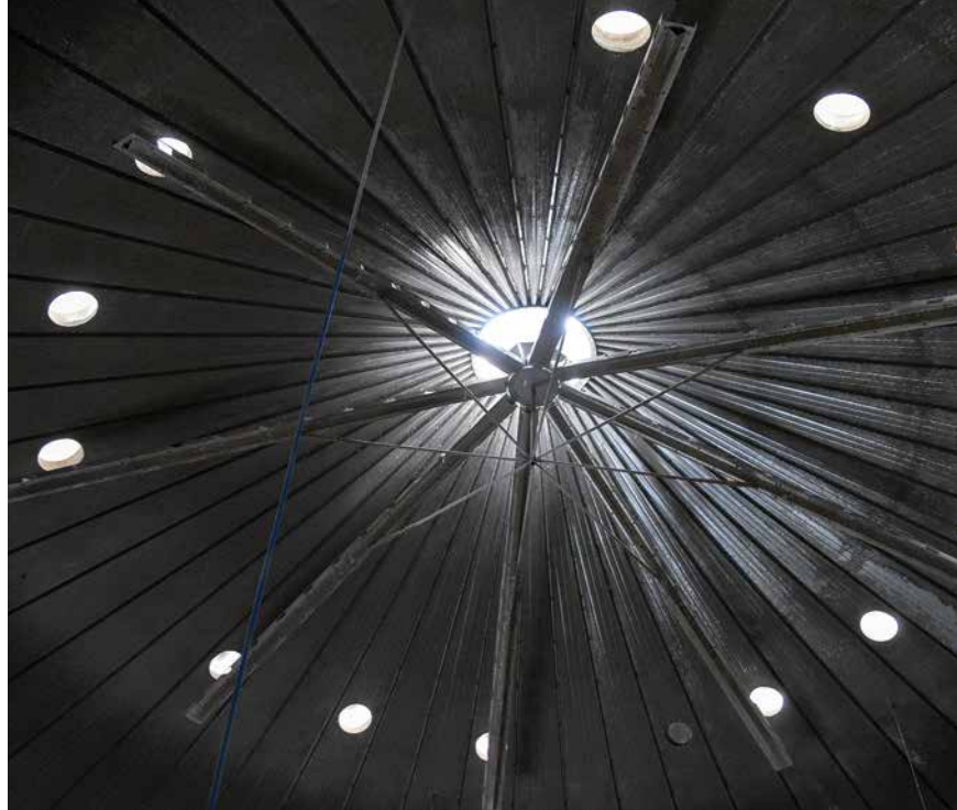
△ Die Förderschnecke zum Einlagern ist zweigeteilt. Der starre Teil wird per Traktor positioniert. Der kürzere Teil lässt sich dann hinter einen Kipper schwenken. Die Schnecke fördert das Getreide von oben ins Silo. Ein drehender, achtarmiger Stern verteilt das Getreide gleichmäßig.
